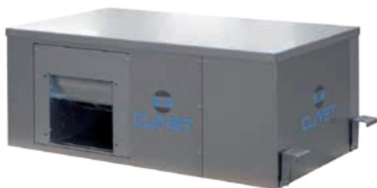
**VERSATEMP EVH-X** это **высокоэффективный автономный кондиционер**, который автоматически нагревает или охлаждает помещения в течение всего года, используя **воду как источник**. Благодаря роторному компрессору, электронному ТРВ, пластинчатому теплообменнику и многоскоростному вентилятору, достигается **высокий уровень энергоэффективности и надежности** во время эксплуатации.
